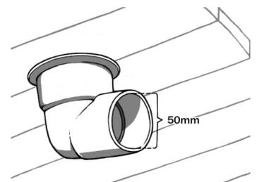
buisaansluiting voor slangen met een binnendiameter van 32 tot 38 mm, of gebruik een andere passende afvoerbuis of schroefslang.
