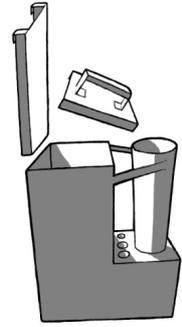
SIDE och TUBE kaminernas eldstad har två stycken rostar och ett kompakt L-järn. De placeras på stöden i kaminen som bilden visar. L-järnet placeras med den vikta kanten uppåt i främre delen av eldstaden, på så vis styr det luftflödet och håller samtidigt veden bättre på plats. Dessa ska vara på plats alltid då man använder kaminen. (Bilden till höger)
