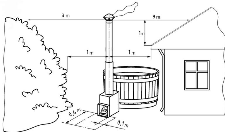
I kaminer med normal eldstad (SIDE, CUBE, TUBE) måste man även beakta brandsäkerheten. Framför eldstaden får inte finnas lättantändligt material, i praktiken ska området, som bilden visar, bestå av brandsäkert material, såsom betong, sand eller plåt.
