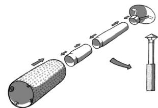
защитную плёнку с кожуха дымовой трубы и установите собранную трубу в выходное отверстие печи.
