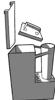
De SIDE, CUBE en TUBE kachels worden geleverd met twee roosters en een stevige L-vormige metalen plaat. Deze worden in de kachel geïnstalleerd op de daarvoor bestemde dragers zoals aangegeven in de afbeelding. De rand van de L-vormige plaat dient naar boven te wijzen, zodat deze het brandhout beter op zijn plaats houdt. Deze onderdelen dienen bij gebruik van de kachel altijd te zijn geplaatst. (Zie afbeelding rechts)
