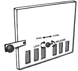
**Наружные водогрейные печи CUBE, TUBE и SIDE** так же просты в эксплуатации, как обычные печи. Тяга регулируется при помощи решётки дверцы топки: для этого нужно ослабить крепёжные болты решётки, поставить её в нужное положение, и затянуть болты до необходимого эффекта.
