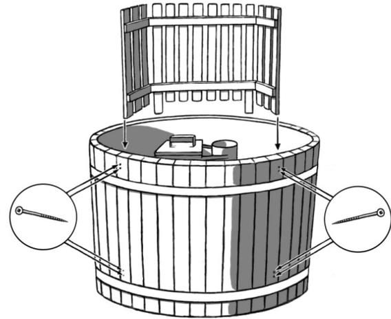
Наружные печи моделей CUBE и TUBE поставляются в разобранном виде в комплекте с необходимыми деталями и инструкцией по сборке. Убедитесь, что наружные швы колонки герметичны, а крепление к бочке надежно. Камин не нагревается выше температуры воды, поскольку окружен водяным контуром. Тем не менее, труба и дверца печи нагреваются. Дополнительно можно заказать подставку для напитков/защитное ограждение, которые крепятся к колонке и купели.
