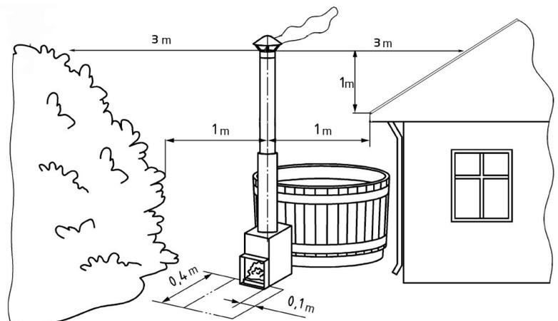
Let op de brandveiligheid van de haard in normale kachels (SIDE, CUBE, TUBE). Er mag zich direct voor de kachel geen brandbaar materiaal bevinden (zie afbeelding). De ondergrond dient daar te zijn gemaakt van beton, zand of een metaalplaat. De kachel wordt niet warmer dan de temperatuur van het water, omdat de kachel wordt omgeven door een watermantel. De schoorsteen en de deur van de kachel worden echter wel heet. Raadpleeg zo nodig uw plaatselijke brandweer.
