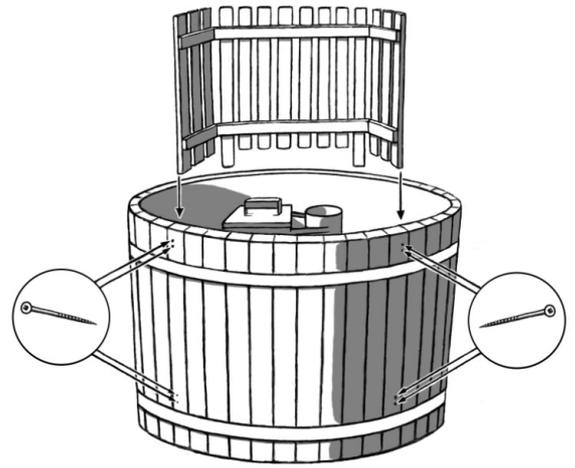
De externe CUBE en TUBE kachels worden ongemonteerd geleverd en in de verpakking van de kachel vindt u modelspecifieke instructies en toebehoren. Zorg ervoor dat de bevestigingen aan de kuip waterdicht zijn. De optionele modelspecifieke bekerhouder/beschermplaat waarmee de kachel kan worden bevestigd.
