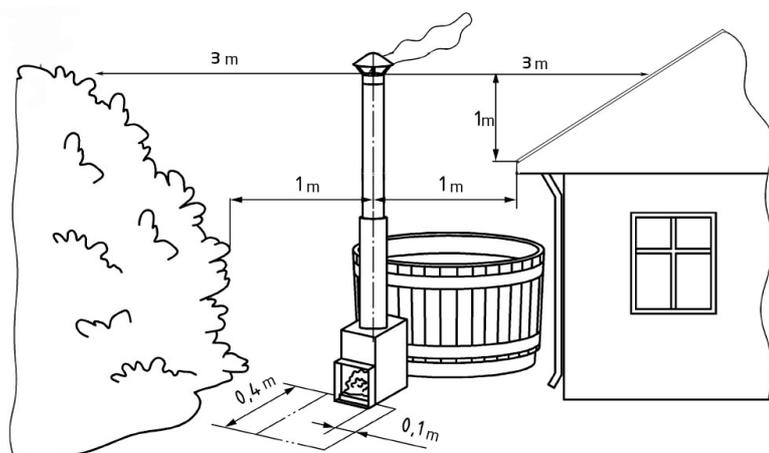
Avec les poêles normaux (SIDE, CUBE, TUBE), il faut prendre en compte la sécurité incendie à proximité du feu, ce qui signifie qu'aucun matériel inflammable ne doit se trouver à proximité du foyer du feu, en pratique, une zone
