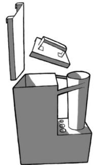
Deux grilles à tuyère et une plaque de fer en L fermée doivent être placées dans le foyer des poêles SIDE et TUBE. Elles se placent sur les supports du poêle comme indiqué sur l'image. La plaque de fer en L se place en haut, sur le bord replié avant du foyer afin de diriger l'air et mieux maintenir les bûches dans le foyer. Les bûches doivent toujours se trouver à leur place lorsque vous utilisez le poêle. (Image de droite)
