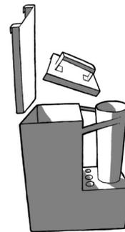
В печах типа SIDE и TUBE в топке расположено две колосниковые решётки и одна сплошная L-образная плита. Они устанавливаются внутрь печи на специальные опоры, как показано на рисунке. L-образная плита, расположенная ближе всех к краю топки, своим загнутым краем направляет воздушный поток, а также помогает наилучшим образом распределить дрова внутри топки. Следите за тем, чтобы при эксплуатации печи решётки всегда были на месте (см. рисунок справа).
