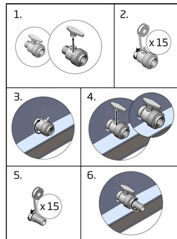
наружную резьбу корпуса клапана фум-лентой примерно 15 раз утолщая резьбу в сторону основания.
