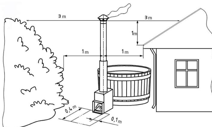
La zone devant et sous le foyer doit être libre de toute matière inflammable. En pratique, utilisez une matière ininflammable dans cette zone, comme le béton, le sable ou une plaque de métal, tel qu'indiqué sur le dessin. Le poêle ne chauffe pas à une température supérieure à celle de l'eau car il est entouré par une couche d'eau. Cependant, la cheminée et le clapet du poêle chauffent.
