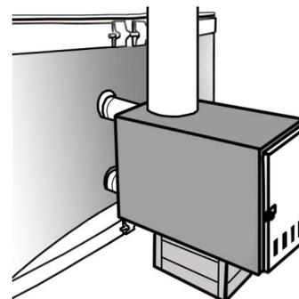
1. Подсоедините верхнюю резиновую трубку к печи и затяните хомут, который расположен на стороне печи.
