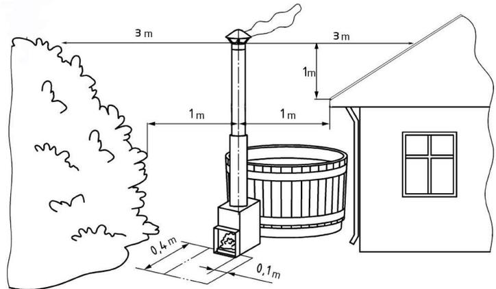
Vor dem Ofen sollten sich keine brennbaren Materialien befinden. Es sollte da einen Bereich aus nicht brennbarem Material wie Beton, Sand oder Metall geben, wie im Bild gezeigt. Der Ofen wird nicht heißer als die Wassertemperatur, da er vom Wassermantel umgeben ist. Der Abzug des Ofens und die Klappe werden jedoch heiß.
