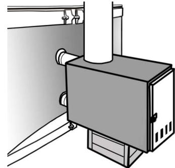
1. Schließen Sie das obere Gummirohr am Ofen an und ziehen Sie die Schlauchschelle auf der Ofenseite fest an.
