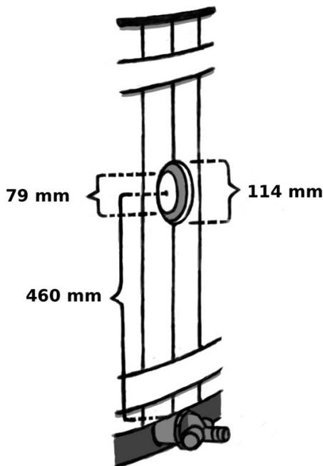
Kirami muovitynnyriin läpivientisarjan asennus on hyvin yksinkertainen, vain yhdelle läpiviennille täytyy porata reikä. Itse muoviiin porataan Ø79mm reikä ja **panelointiin** samalle kohtaa >Ø114mm reikä. Verhoilussa oleva reikä tulee olla isompi jotta läpiviennin saa kiristettyä ja osat mahtuu kiertämään paikoilleen.
