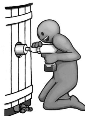
Муфта вставляется в пластик таким образом, чтобы канавка в уплотнении находилась с обеих сторон пластиковой стенки бочки, после этого муфта тщательно затягивается.
