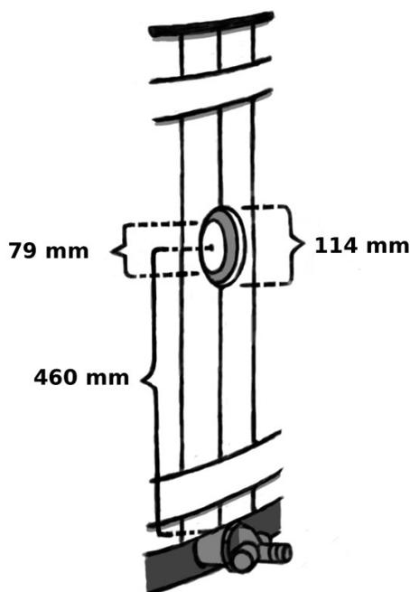
L'installation de l'ensemble du passe-cloison sur un bain nordique en plastique Kirami est extrêmement simple, seul un passe-cloison requiert un perçage. Il faut percer un trou de  $\varnothing 79$  mm dans le plastique et un trou de  $> \varnothing 114$  mm sur la latte en bois au même endroit. Le trou du revêtement doit être plus grand afin de pouvoir serrer le passe-cloison et permettre aux pièces de tourner.
