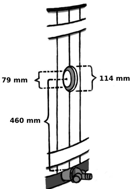
Установка проходных муфт в пластиковую бочку Kirami довольно простая, для каждого прохода нужно просверлить отверстие. В пластике требуется просверлить отверстие Ø79 мм и в том же месте в деревянной панели отверстие диаметром >Ø114 мм. Отверстие в обшивке будет больше, для того, чтобы можно было затянуть муфту и закрепить детали на место.
