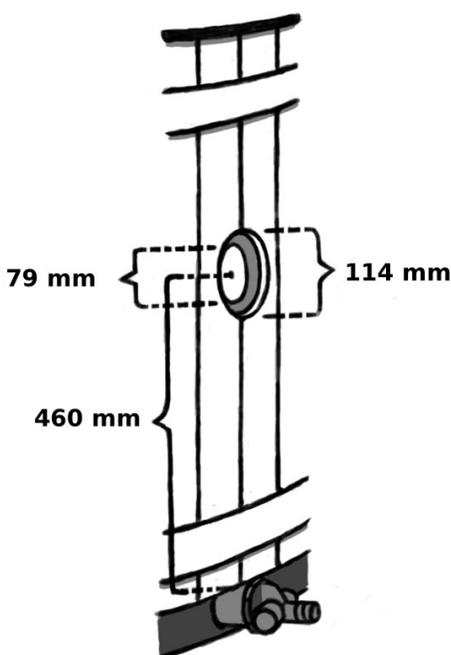
Die Installation des Zulaufsystems an das Kirami-Kunststofffass ist ganz einfach: es muss nur ein Loch für eine Buchse gebohrt werden. In den Kunststoff selbst wird ein Loch von 79 mm Ø gebohrt und in die Holzverkleidung an die gleiche Stelle ein Loch von >114 mm Ø. Das Loch in der Verkleidung sollte größer sein, damit die Buchse festgezogen werden und das Ventil verschraubt werden kann.
