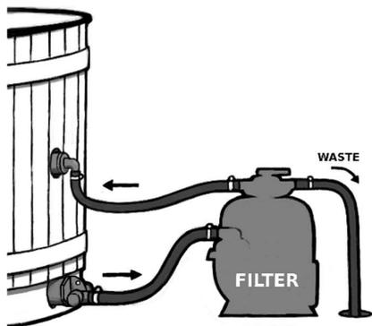
Couper le tuyau en deux ou trois morceaux de taille suffisante. La troisième partie peut être raccordée au filtre à sable pour évacuer les eaux sales du filtre. Des colliers de serrage sont fournis pour ces raccords de tuyaux.
