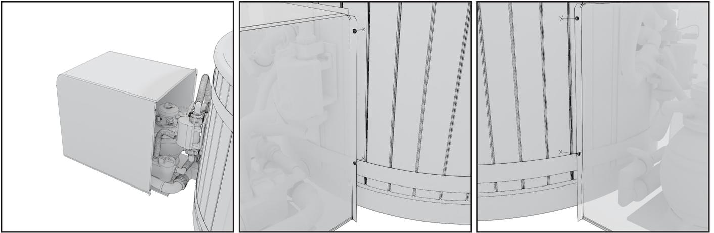
10. Stülpen Sie die Schutzhülle über das Flow-System. Die Schutzhülle hat vier Druckknöpfe. Markieren Sie die Positionen der Druckknöpfe für die Verkleidung.
