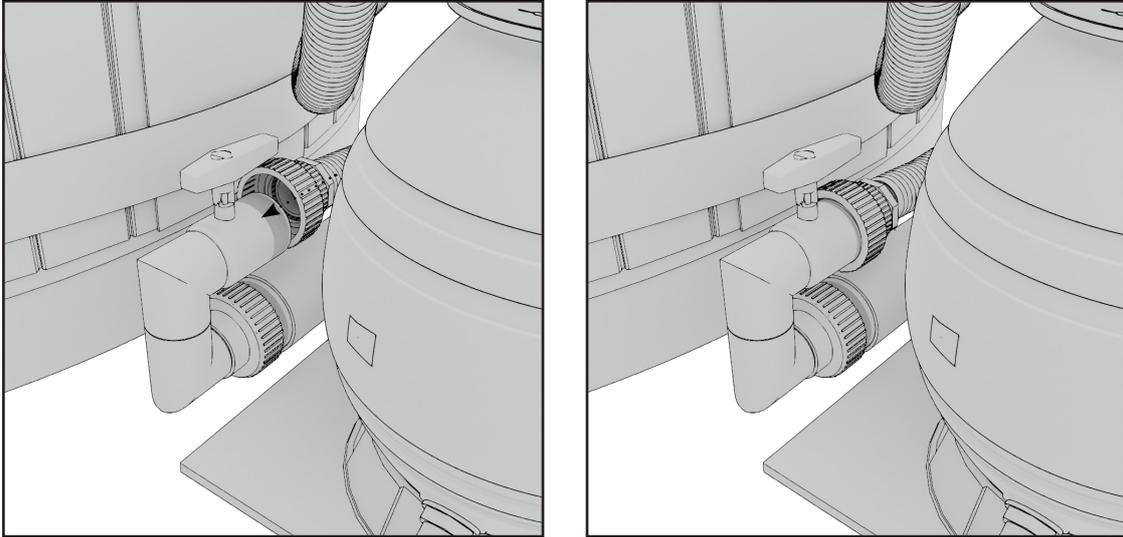
9. Raccordez le tuyau provenant du filtre à l'ensemble des tuyaux installés dans la jonction en T (2).
