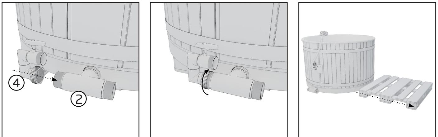
2. Befestigen Sie den Rohrsatz (4) so am linken Ausgang des T-Stücks (2), dass der Winkel nach oben zeigt. Stellen Sie sicher, dass der O-Ring am Anschluss des T-Stücks richtig sitzt. Entfernen Sie danach vorsichtig die Palette unter dem Fass, um die gerade eingebauten Teile nicht zu beschädigen.
