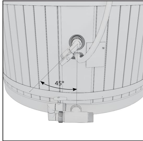
4. Schroef de set pijpen (5) in de verloopnippel. Zorg ervoor dat de O-ring goed op de verloopnippel zit.
