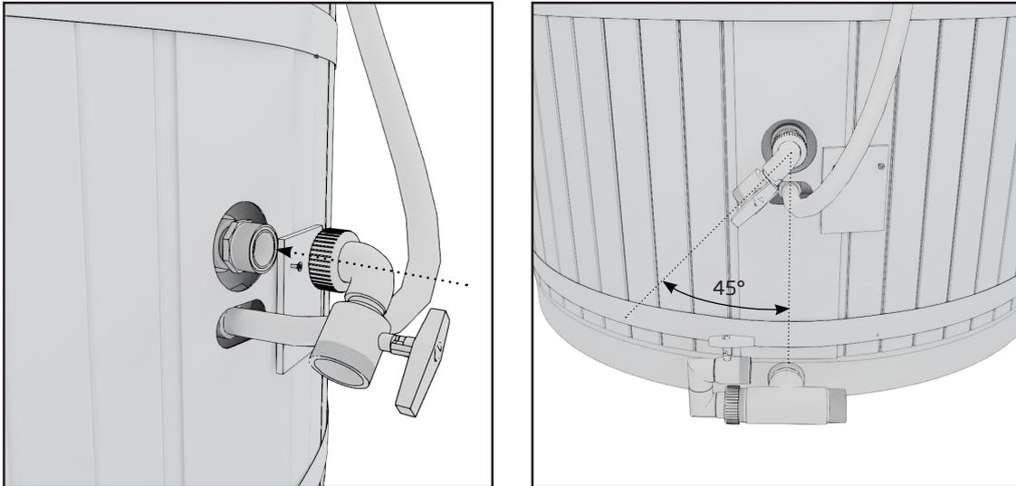
4. Vissez le jeu de tuyaux (5) dans l'embout de réduction. Assurez-vous que le joint torique est bien en place sur l'embout de réduction.
