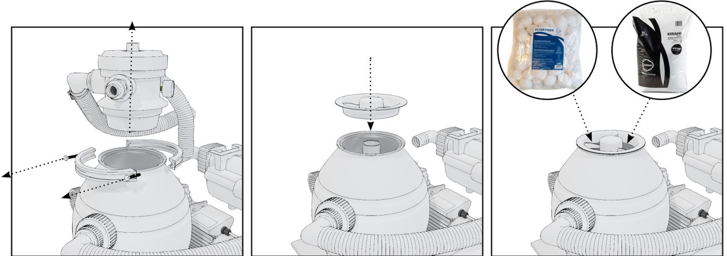
Koppla loss 4-vägsventilen från massfilterbehållaren. Lägg påfyllningsskyddet på behållaren för att säkerställa att filtreringsmassa inte hamnar i centralröret inne i behållaren.
