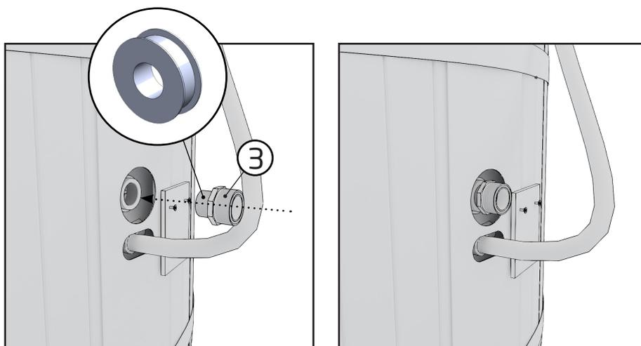
3. Kierrä supistusnipa (3) altaan seinässä olevaan venttiliin. Käytä pienemmässä kiertessä putkiteippiä noin 15 kierrosta, älä laita putkiteippiä isompaan kierteseen.
