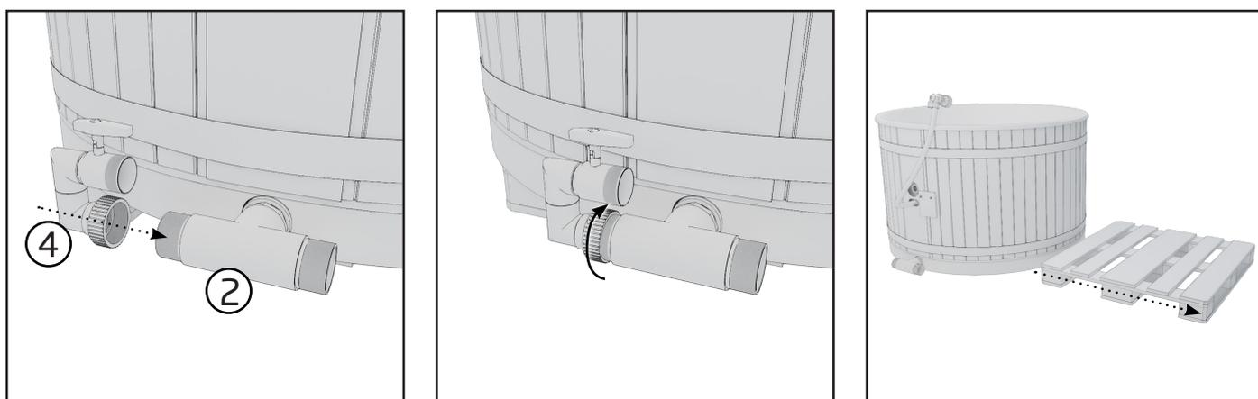
2. Fixez le jeu de tuyaux (4) dans la sortie gauche de la jonction en T (2) de manière à ce que l'angle soit orienté vers le haut. Assurez-vous que le joint torique est bien en place au niveau de la connexion de la jonction en T. Ensuite, retirez avec précaution la palette qui se trouve sous le spa pour éviter d'endommager les pièces que vous venez d'installer.
