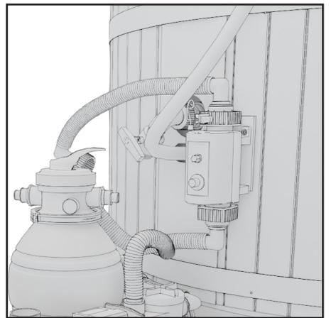
5. Asettele pääyksikkö tynnyrin viereen. Varmista että painemittari on on kuvan osoittamassa kohtaa. Käännä 4-tieventtiiliä tarvittaessa. Nosta lämmitysyksikkö altaan seinällä olevaan telineeseen.
