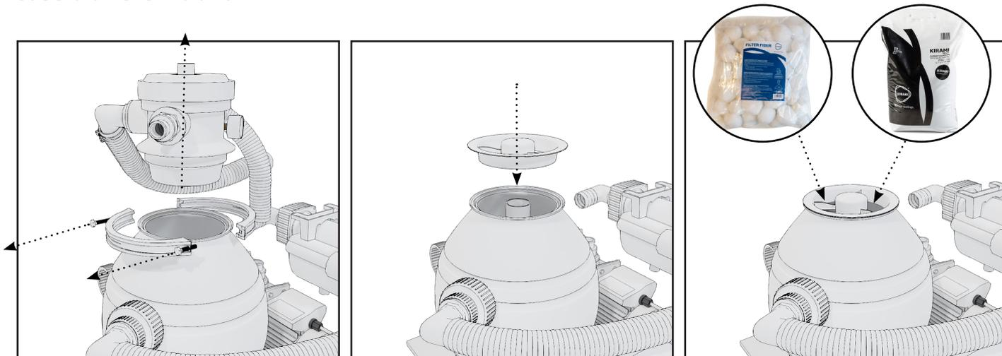
Rimuovere la valvola a quattro vie dal serbatoio del filtro. Posizionare la protezione di riempimento sopra il serbatoio per evitare che il filtro a massa entri nel tubo centrale all'interno del serbatoio.
