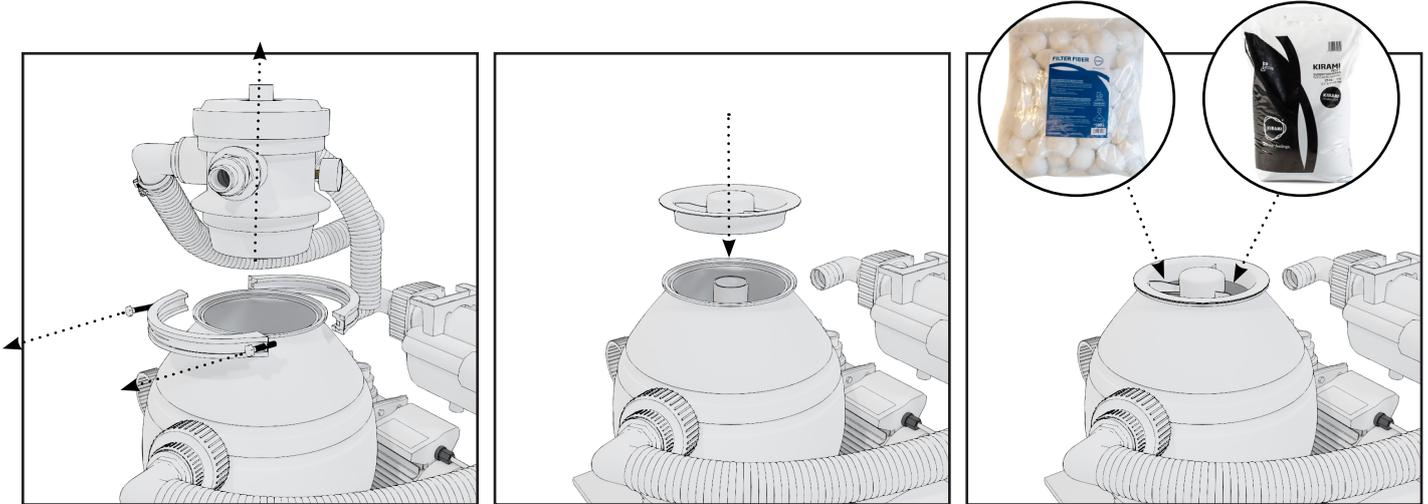
Entfernen Sie das 4-Wege-Ventil vom Filterbehälter. Legen Sie den Einfüllschutz über den Behälter, um sicherzustellen, dass die Filtermedium nicht in das zentrale Rohr im Behälterinneren gelangt.
