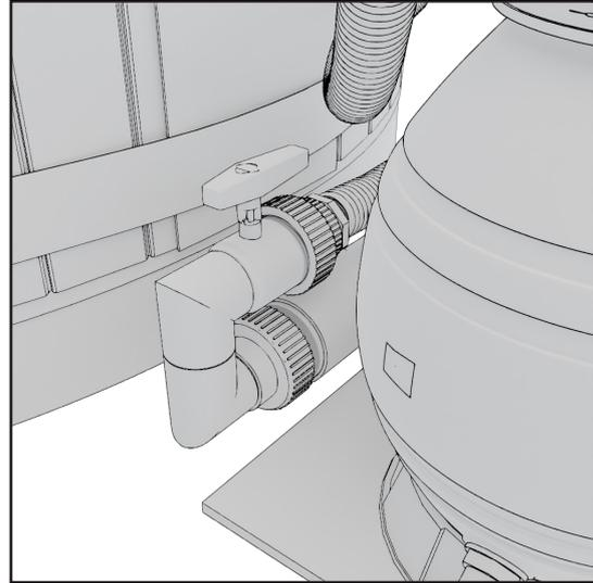
9. Verbinden Sie den vom Filter kommenden Schlauch mit dem am T-Stück (2) installierten Rohr-
