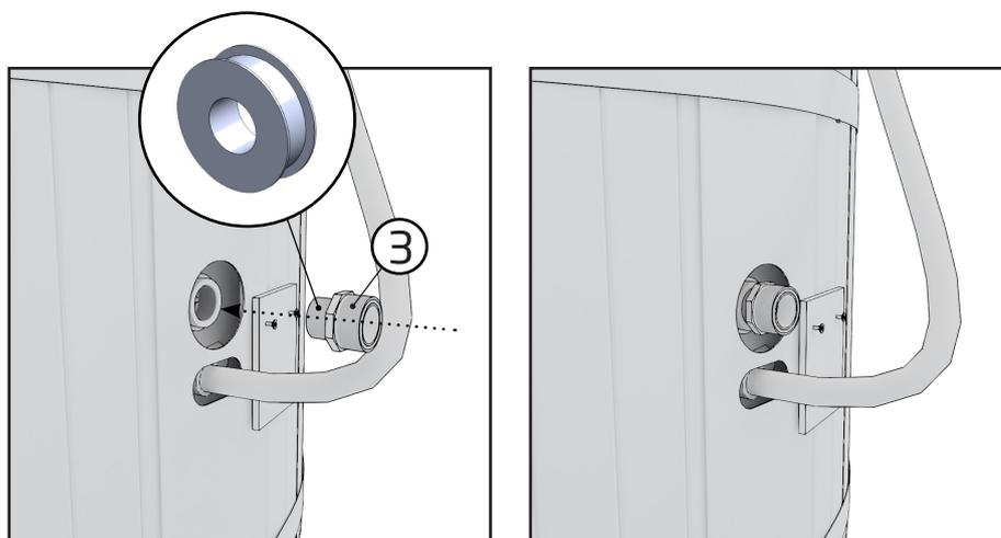
3. Drehen Sie den Reduziernippel (3) auf das Ventil an der Beckenwand. Verwenden Sie Dichtband um das kleinere Gewinde herum und wickeln Sie es mit etwa 15 Umdrehungen. Bringen Sie an dem größeren Gewinde kein Dichtband an.
