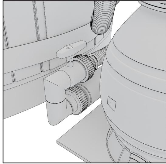
9. Verbind de slang die van het filter komt met de set pijpen die op het T-stuk zijn bevestigd (2).
