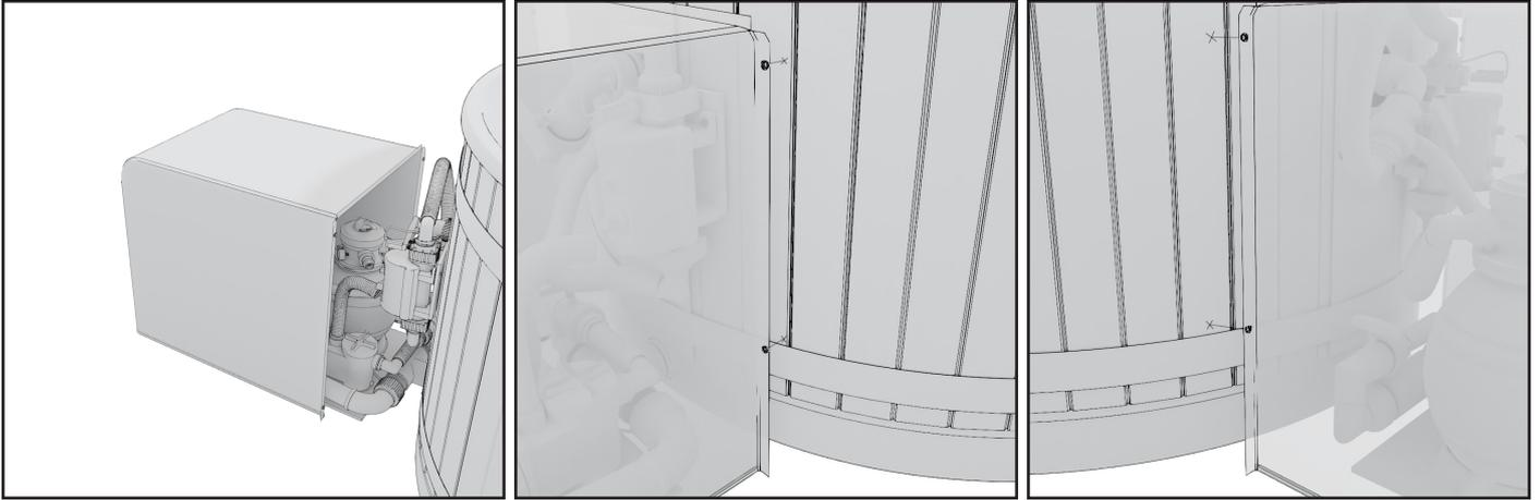
10. Placez la coque de protection sur le système de débit. La coque de protection comporte quatre boutons. Marquez les positions des boutons pour le lambris.
