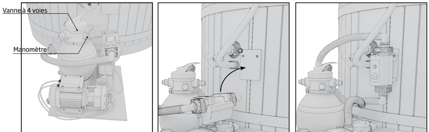
5. Placez l'unité principale à côté du bain nordique. Veillez à ce que le manomètre soit positionné comme indiqué sur l'illustration. Tournez la vanne à 4 voies si nécessaire. Soulevez et placez l'unité de chauffage sur le support situé sur la paroi du spa.
