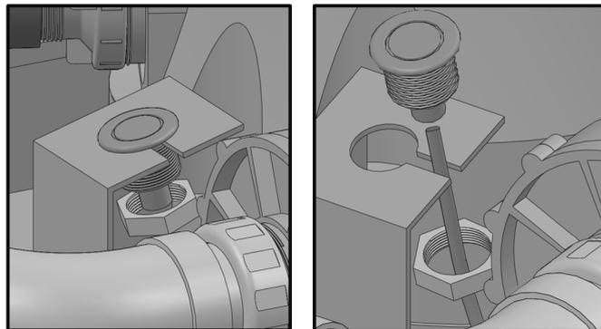
Die Start-Taste befindet sich standardmäßig auf dem Gehäuse des Durchflusssystems. Die Taste kann an die von Ihnen gewünschte Stelle verschoben werden. Die Taste wird durch Lösen der Mutter auf der anderen Seite entfernt. Das Rohr/der Schlauch kann ebenfalls abgenommen werden.
