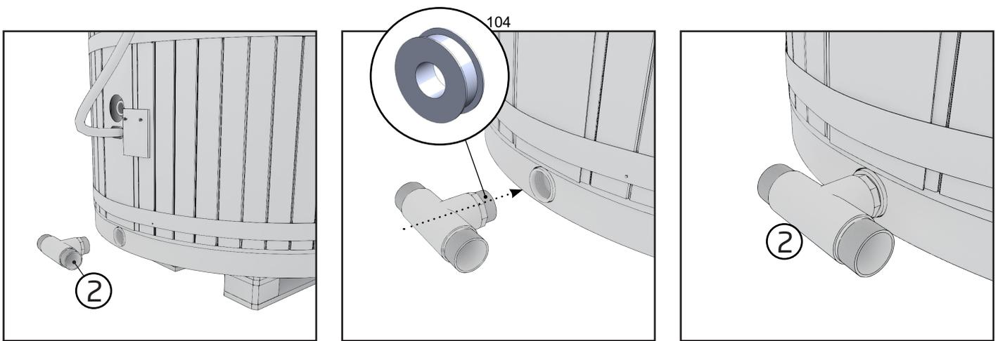
1. Lasciare il pallet sotto la tinozza e avvitare il raccordo a T (2.) nell'uscita della tinozza. Utilizzare abbondante nastro per tubi. Smettere immediatamente di ruotare il raccordo a T quando si trova in posizione orizzontale, poiché la sua rotazione all'indietro verso la posizione aperta può causare una perdita nella parte coperta dal nastro
