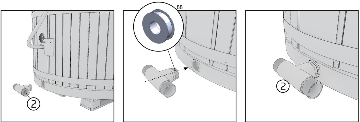
1. Laat de pallet onder het bad staan en schroef het T-stuk (2.) in de afvoer van de hottub. Maak overvloedig gebruik van ducttape. Zodra het T-stuk zich in de horizontale positie bevindt, stopt u met draaien. Indien u het terug naar de open positie draait, kan er namelijk een lek ontstaan in de tape-afdichting.
