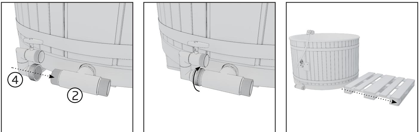
2. Skruva fast rörsatsen (4) i T-förgreningens (2) vänstra utlopp så att hörnet pekar uppåt. Kontrollera att det finns en O-ring installerad i T-förgreningens skarv. Ta därefter försiktigt bort lastpallen under badtunnan så att delarna som du just monterade inte går sönder.
