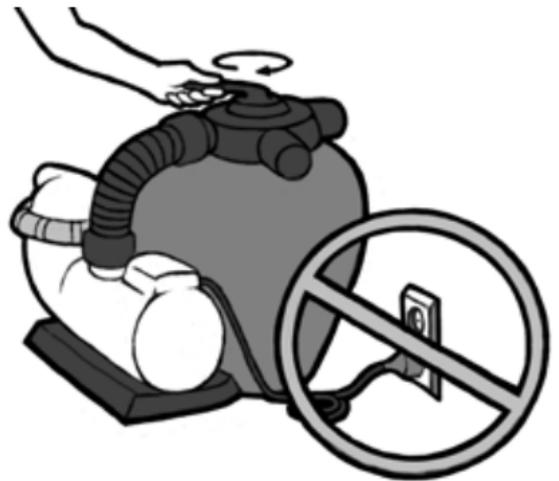
Vor dem Drehen des Bedienhebels muss die Pumpe stets ausgeschaltet werden.
