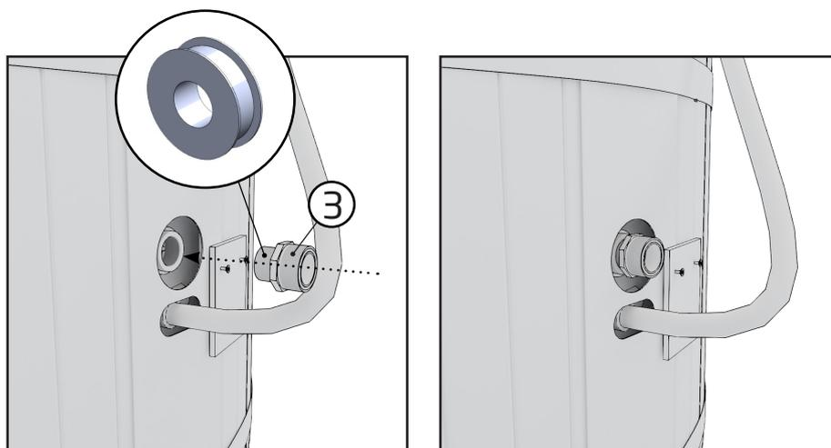
3. Avvitare il riduttore (3) alla valvola sulla parete della piscina. Utilizzare il nastro per tubi intorno alla filettatura più piccola, effettuando circa 15 giri. Non applicare il nastro per tubi alla filettatura più grande.
