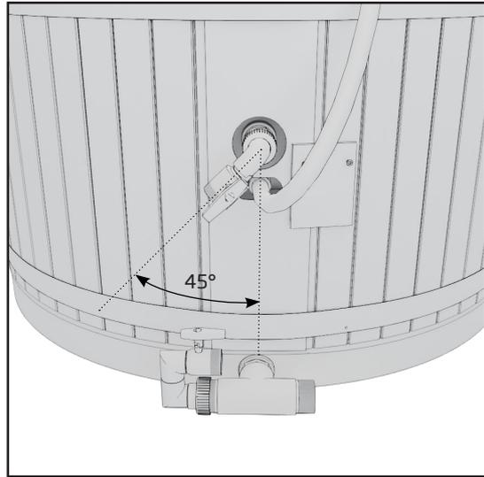
4. Avvitare il set di tubi (5) nel riduttore. Assicurarsi che il riduttore abbia la guarnizione O-ring in posizione.
