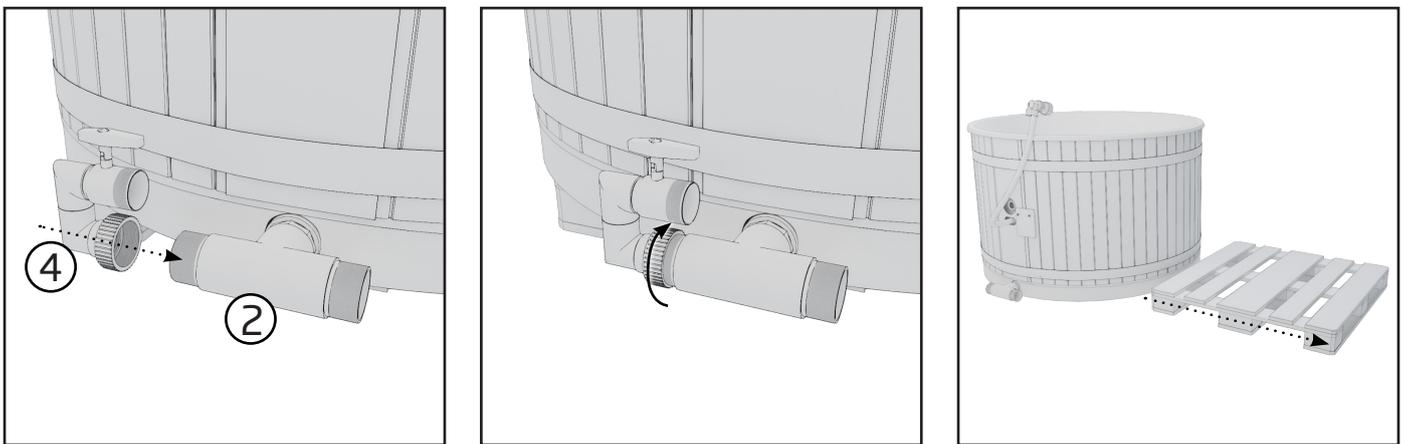
2. Bevestig de set pijpen (4) in de linkeruitgang van het T-stuk (2) zodat de hoek naar boven is gericht. Zorg ervoor dat de O-ring vastzit ter hoogte van de aansluiting van het T-stuk. Hierna verwijdert u de pallet zorgvuldig onder het omhulsel zodat u de juist geïnstalleerde onderdelen niet beschadigt.
