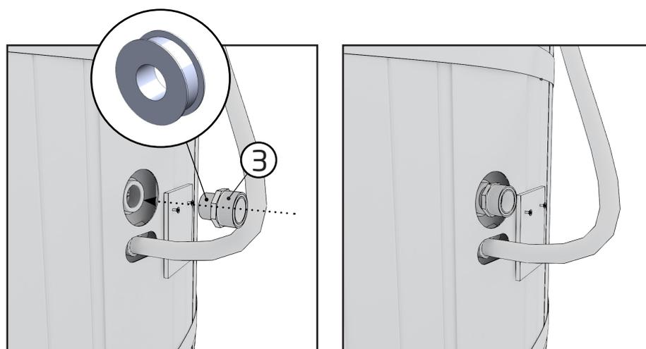
3. Vissez l'embout de réduction (3) sur la vanne située sur la paroi du spa. Utilisez du ruban adhésif autour de la plus petite sortie (faites environ 15 tours). N'appliquez pas de ruban adhésif sur la sortie la plus large.
