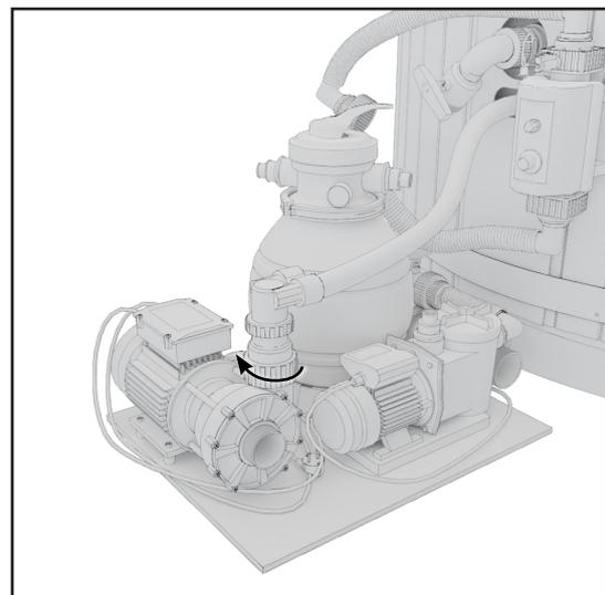
6. Schließen Sie den Schlauch, der von der Seite des Badefasses kommt, an das Durchflusssystem an.
