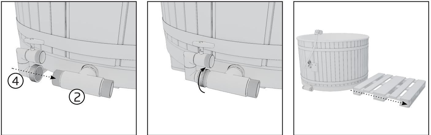
2. Kierrä putkisarja 4) T-haaran (2) vasemman puoleiseen lähtöön siten että kulma osoittaa ylöspäin. Varmista että T-haaran liitoksessa on O-rengas paikallansa. Tämän jälkeen poista kuormalava tynnyrin alta varovasti ettei juuri asentamasi osat rikkoudu.
