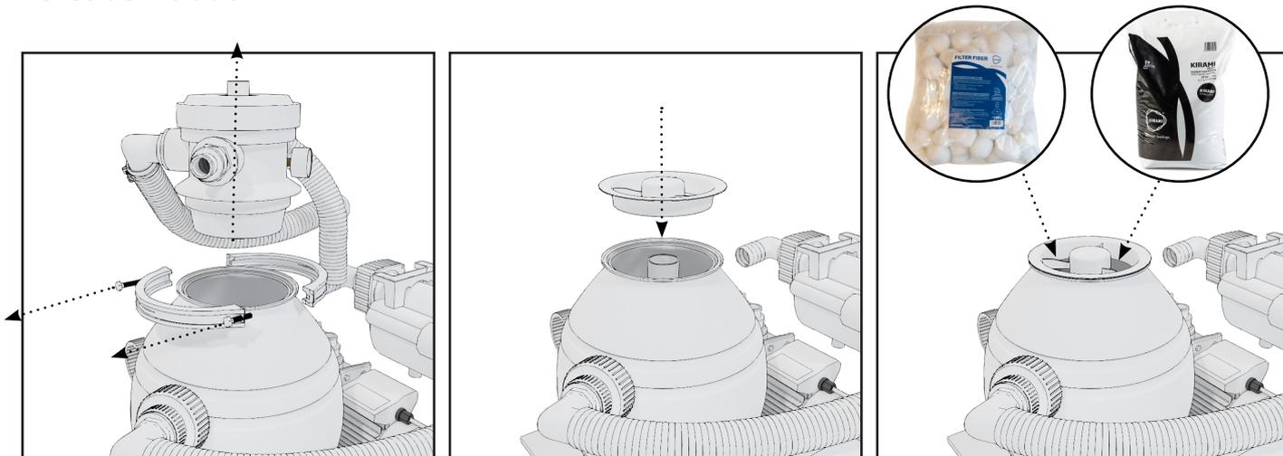
Retirez la vanne à quatre voies du réservoir de la cuve. Placez le couvercle de protection sur le réservoir pour éviter que la masse de filtration ne pénètre dans le tuyau central qui se trouve à l'intérieur de la cuve.
