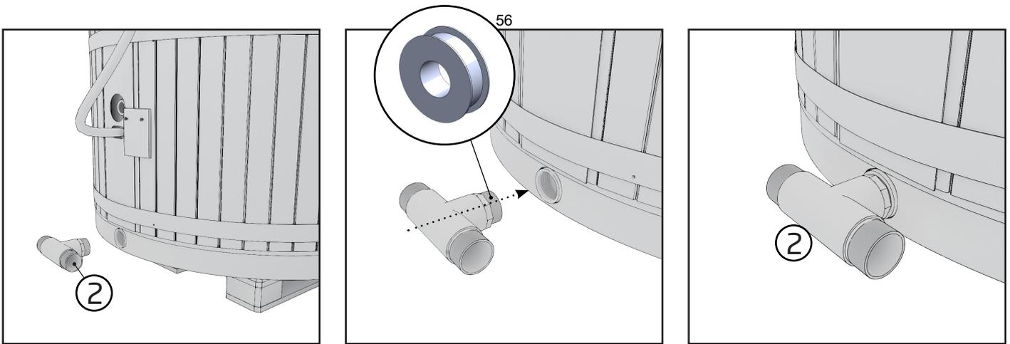
1. Belassen Sie die Palette unter dem Badefass und schrauben Sie das T-Stück (2.) in den Auslass des Beckens. Verwenden Sie reichlich Klebeband. Hören Sie sofort auf, das T-Stück zu drehen, wenn es sich in der waagerechten Position befindet, denn wenn Sie es in die offene Position zurückdrehen, kann die Bandabdichtung undicht werden.
