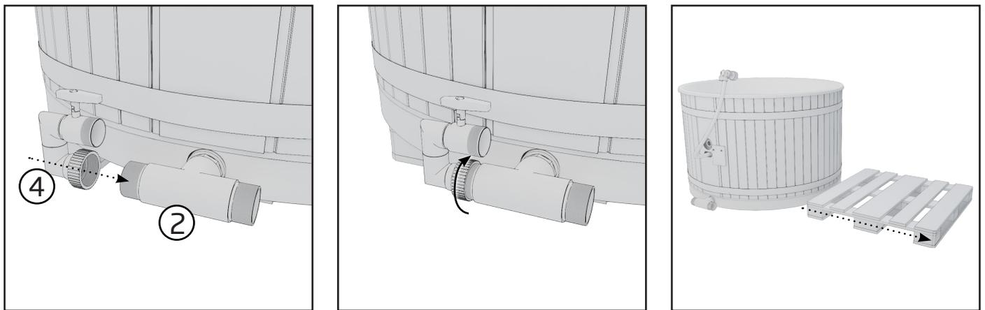
2. Collegare il set di tubi (4) all'uscita sinistra del raccordo a T (2) in modo che l'angolo sia rivolto verso l'alto. Assicurarsi che la guarnizione O-ring sia in posizione sul raccordo della giunzione a T. A questo punto, rimuovere con cautela il pallet da sotto il barile per evitare di danneggiare le parti appena installate.
