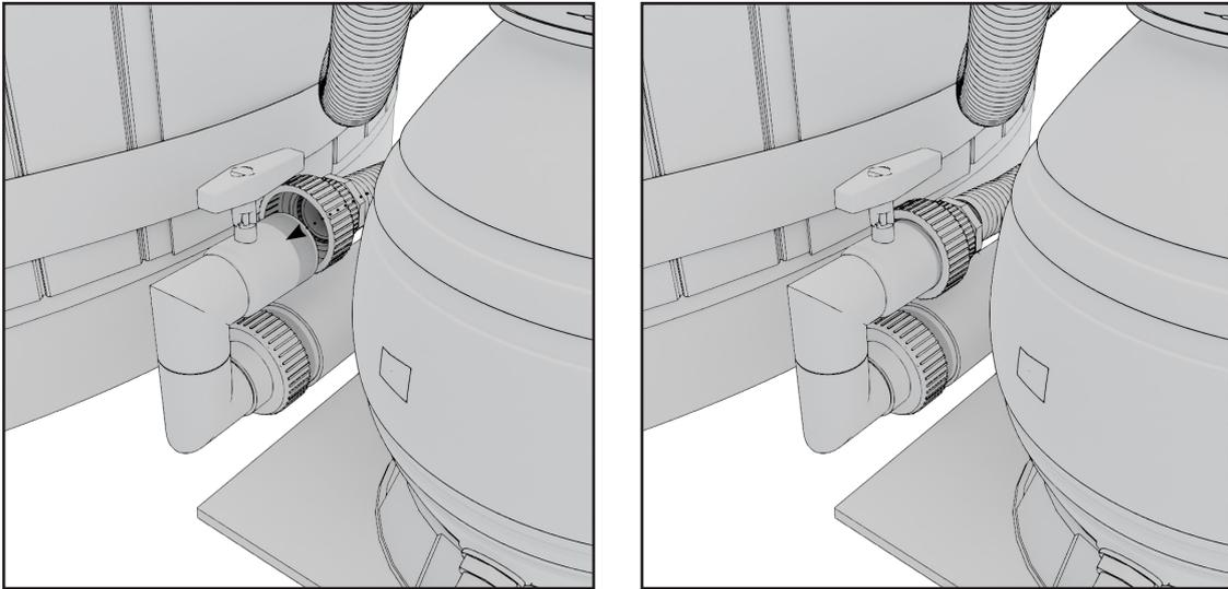
9. Collegare il tubo proveniente dal filtro alla serie di tubi installati nel raccordo a T (2).
