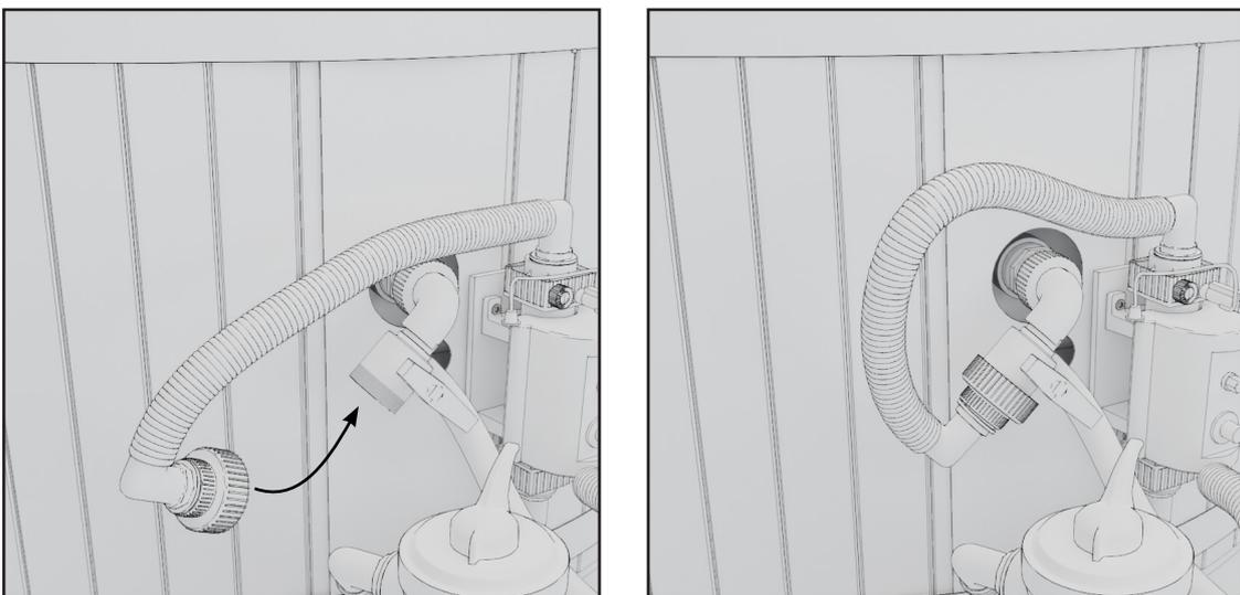
9. Raccordez le tuyau de l'unité de chauffage à l'ensemble des tuyaux situés sur la paroi du spa.
