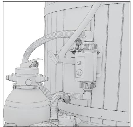
5. Stellen Sie das Hauptgerät neben das Badefass. Stellen Sie sicher, dass das Manometer gemäß Abbildung positioniert ist. Drehen Sie ggf. das 4-Wege-Ventil. Heben Sie die Heizeinheit auf das Gestell an der Wand des Badefasses.
