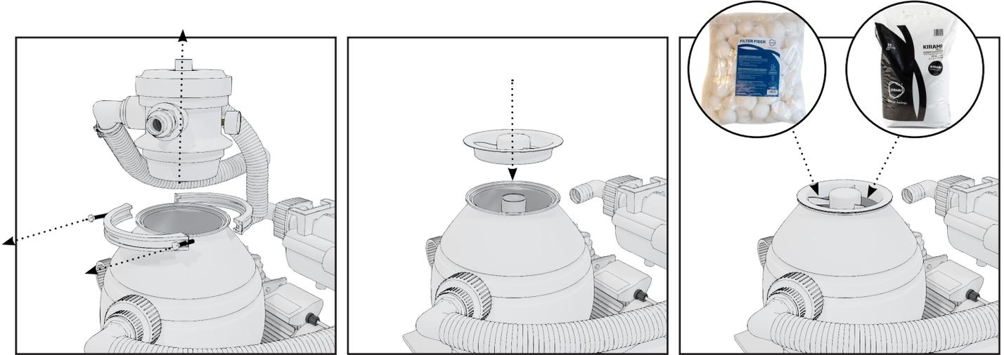
Irroita nelitieventtiili massasuodattimen säiliöstä. Asettele täyttösuoja säiliön päälle varmistakseen ettei suodattusmassa mene säiliön sisällä olevaan keskusputkeen.
