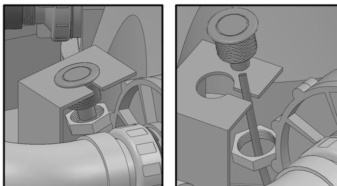
La posizione predefinita del pulsante di avvio si trova sul telaio del sistema di flusso. Il pulsante può essere spostato nella posizione desiderata. Il pulsante viene rimosso allentando verso l'alto il dado sull'altro lato. Anche il tubo/flessibile può essere staccato.
