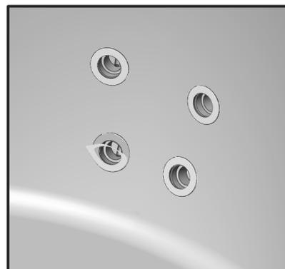
12. Entfernen Sie zum Schluss die Schutzfolie von den Düsen im Inneren des Beckens
