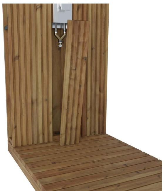
1. Nehmen Sie die beiden Frontpaneelle in der Mitte ab. Die Paneele sind mit vier Schrauben befestigt.
