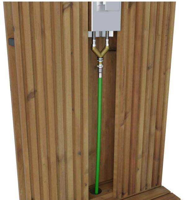
2. Faites passer le tuyau d'arrosage dans le mur par le trou que vous avez percé dans la terrasse et par le trou situé sous la douche de jardin. Raccordez le tuyau d'arrosage à la douche.
