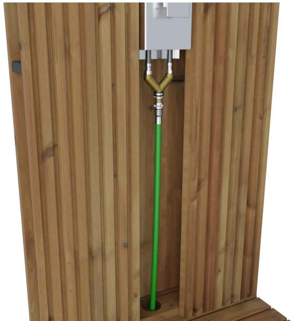
2. Führen Sie den Gartenschlauch in die Wand durch das Loch, das Sie in die Terrasse gebohrt haben, und durch das Loch unter der Außendusche. Schließen Sie den Gartenschlauch an die Dusche an.
