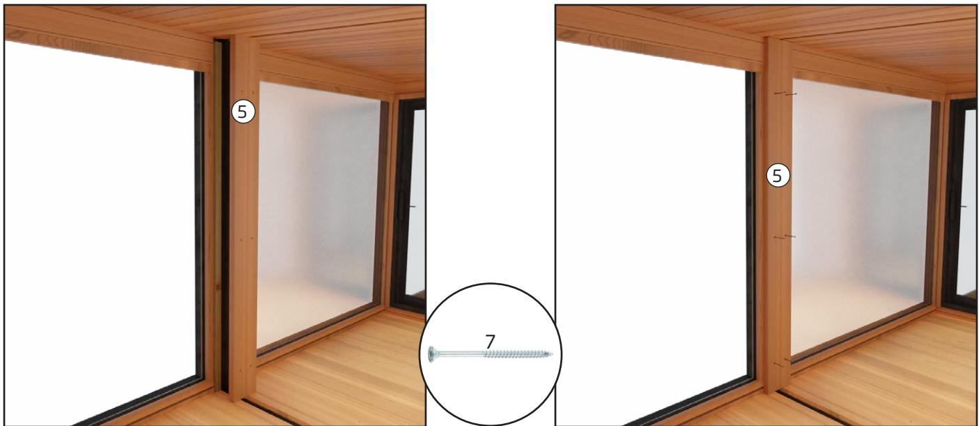
6. Platzieren Sie die Leiste an der Vorderwand zwischen den Modulen und befestigen Sie sie mit sechs Schrauben. Die Leiste hat vorgebohrte Löcher.
