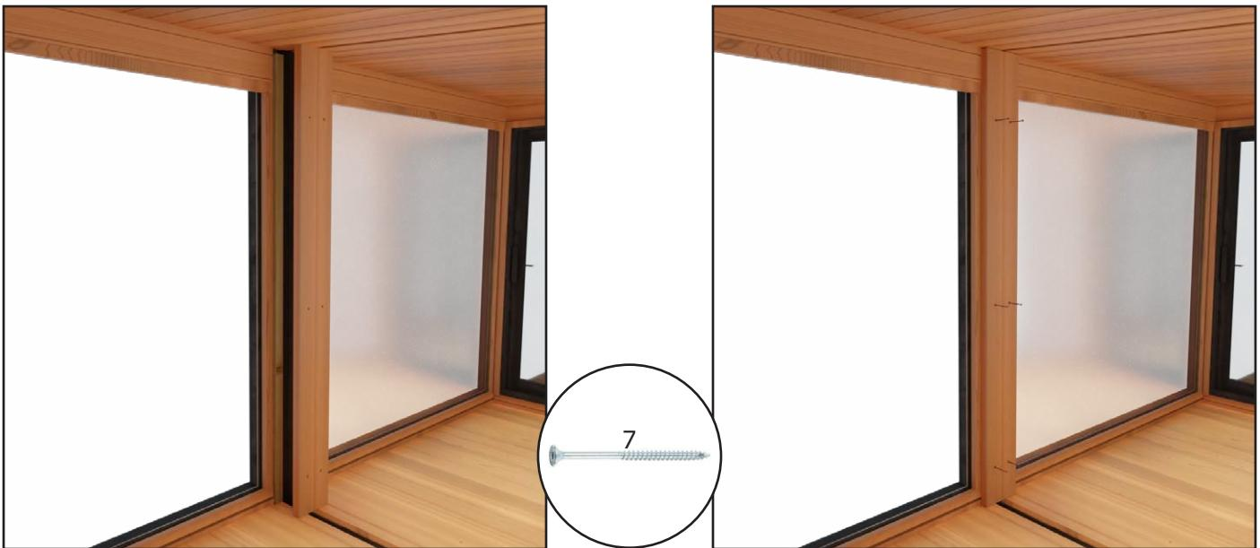
6. Asettele lista etuseinälle moduulien väliin ja kiinnitä kuudella ruuvilla. Listassa on ruuvin reiät valmiina.
