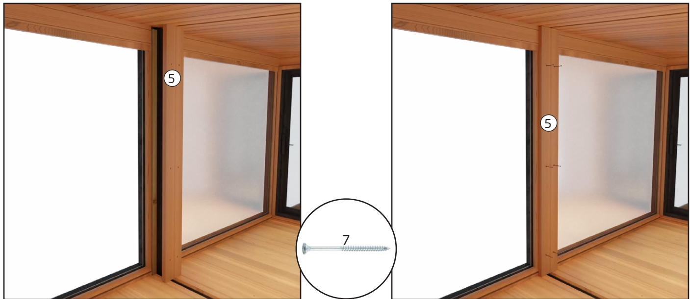
6. Placez la bande sur la paroi avant entre les modules et fixez-la à l'aide de 6 vis. Des trous sont déjà préforés dans la bande.
